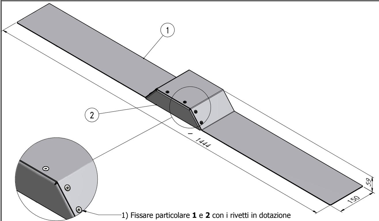
1) Fissare particolare **1** e **2** con i rivetti in dotazione
